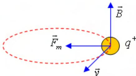
en estas condiciones dicha fuerza no realiza trabajo alguno sobre la partícula porque la fuerza y el desplazamiento son perpendiculares ( $\text{cos } 90^\circ = 0$ ), tampoco cambia el módulo de la velocidad, solo cambia su dirección, por lo tanto la energía cinética de la partícula permanece constante.
