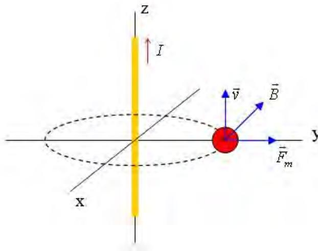
En este caso si se produce fuerza magnética porque el ángulo es de  $90^\circ$  ( $\text{sen } 90^\circ = 1$ ) calculamos primero el campo magnético creado por el conductor a los 5 cm de distancia
